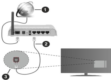
1. Conexión ISP de banda ancha
