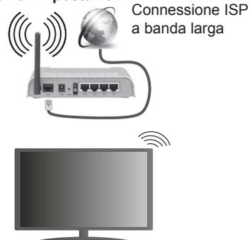
Per aumentare la larghezza di banda, è previsto un router N-wireless (IEEE 802.11a/b/g/n) con bande 2.4 e 5 GHz simultanee. Ottimizzato per uno streaming video HD più fluido e più veloce, trasferimenti file e gioco HD.
