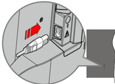
Stecken Sie ein Ende (den Zwei-Loch-Stecker) des mitgelieferten abnehmbaren Netzkabels wie oben gezeigt in den Netzkabeleinlass auf der Rückseite des TV-Geräts. Stecken Sie dann das andere Ende des Netzkabels in die Steckdose.
