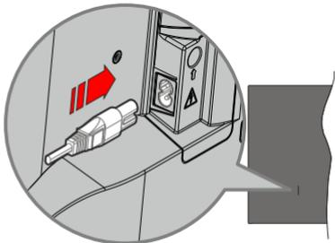
Ligar um das extremidades (ficha de dois polos) do cabo de alimentação amovível fornecido na entrada do cabo de alimentação na parte de trás da TV conforme mostrado acima. Depois ligar a outra extremidade do cabo de alimentação na tomada de corrente eléctrica. TV irá mudar para o modo em espera.
