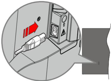
Ligar um das extremidades (ficha de dois polos) do cabo de alimentação amovível fornecido na entrada do cabo de alimentação na parte de trás da TV conforme mostrado acima. Depois ligar a outra extremidade do cabo de alimentação à tomada de corrente elétrica. A TV ligar-se-á automaticamente..
