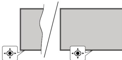
O joystick permite controlar as funções Volume/ Programa/Fonte e Ligação em Espera rápida da TV.
