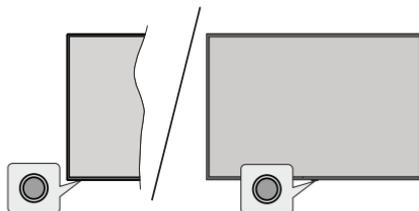
O botão de controle permite-lhe controlar as funções de Configuração Rápida-Ligar da TV.
