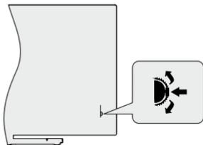
O interruptor de controle permite-lhe controlar as funções Programa e Configuração Rápida-Ligar da TV.
