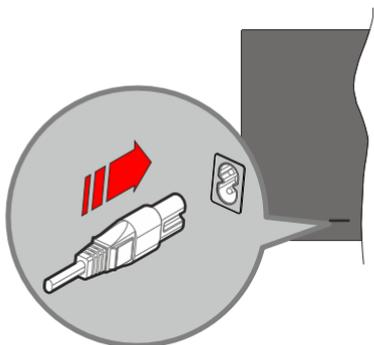
Enchufe un extremo (la clavija de dos orificios) del cable de alimentación desmontable suministrado en la entrada del cable de alimentación situada en la parte trasera de la TV, como se muestra arriba. A continuación enchufe el otro extremo del cable en la toma de corriente de la pared. El televisor se cambiará ahora al modo en espera.
